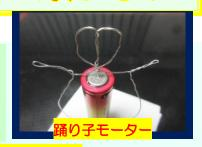
乾電池とコイルで動く「踊り子モーター」と「パラボラ」で 電気と磁気の関係や集光発熱の仕組みを学ぶ実験活動
